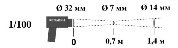
CF2: При наводке на расстояние 700 мм от пирометра диаметр пятна контроля составит 7 мм
