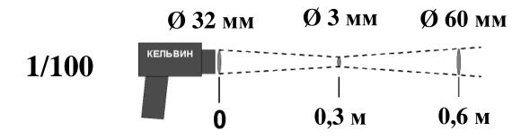
CF1: При наводке на расстояние 300 мм от пирометра диаметр пятна контроля составит 3 мм
